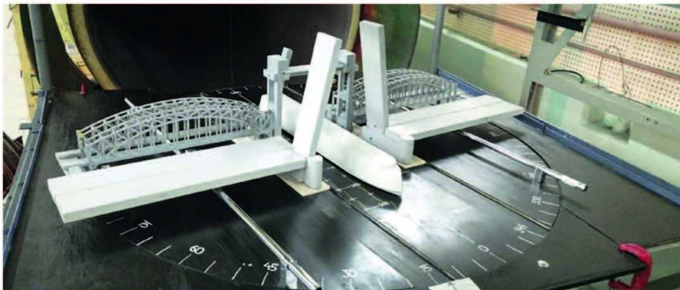
Испытание нового моста через р. Неву в составе ШМСД
